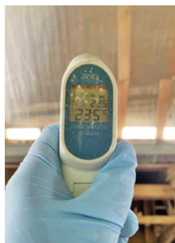
写真2 施工後の屋根裏温度
