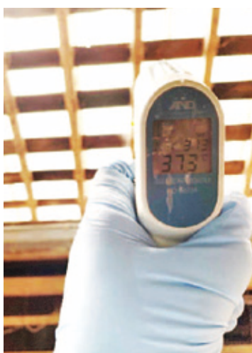
写真1 施工前の屋根裏温度
